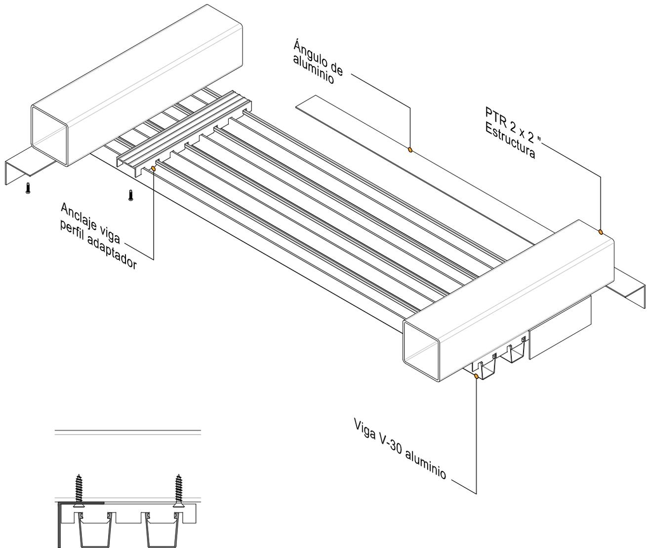
DETALLE ANCLAJE VIGA V-30, PERFIL ADAPTADOR, ÁNGULO DE ALUMINIO A ESTRUCTURA DE ACERO
